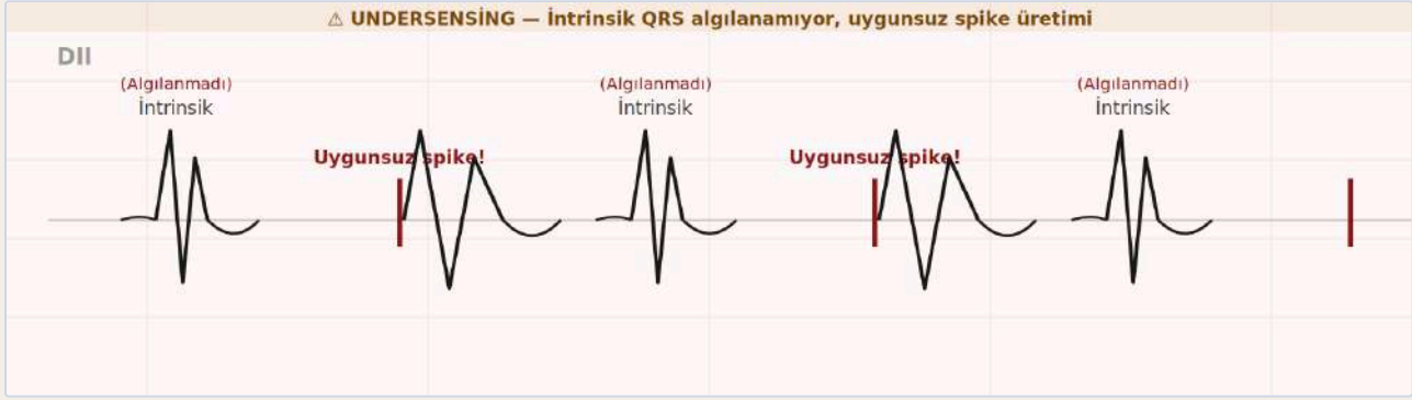
Şekil 17. Undersensing. İntersik QRS kompleksleri algılanmadığından uygunsuz zamanlarda spike üretilmektedir (competitive pacing).
