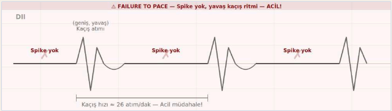
Şekil 20. Failure to pace. Hiç spike üretilmemekte; yavaş idioventriküler kaçış ritmi ( \approx 26 atım/dak) izlenmektedir. Acil müdahale gerektirir.
